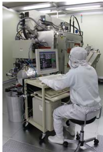
IBD装置(EUV光の反射膜となるMo/Siの超多層膜を積層する装置)
