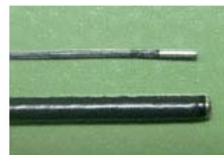
(上)試作微細スコープ(先端硬性部径φ0.8mm)
