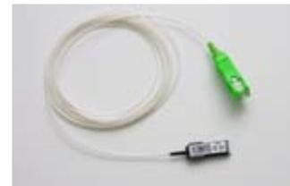
光信号電気信号変換モジュール
