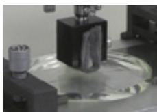
スチールウールに4kgの荷重をかけて、レンズ面を50回往復させる摩耗性耐久試験による。
