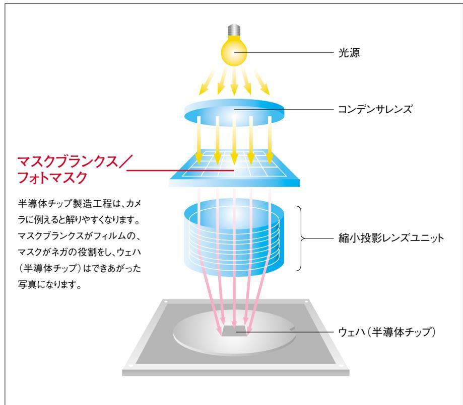
※1 マスクブランクスは表面粗さは、100万分の1ミリメートル(1ナノメートル)、平面度は1,000分の1ミリメートル以下の精度で研磨されています。
