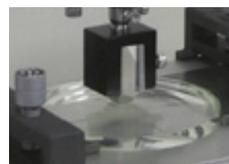
砂消しゴムに1kgの荷重をかけて、レンズ面を100回往復させる摩耗性耐久試験による。
