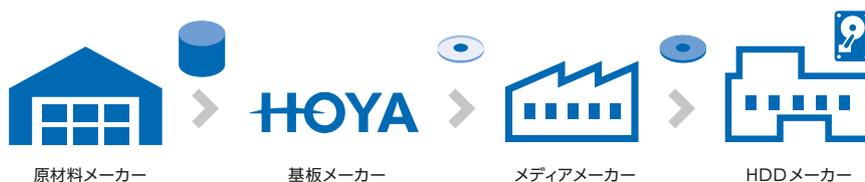
HOYAは、原材料メーカーから基板原材料を仕入れ、これに対し、円盤形加工・強化・研磨などを行い出荷します (基板製造)。
