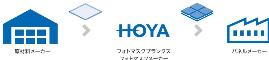
HOYAは、原材料メーカーから基板を仕入れ、基板に対して研磨・成膜・レジスト塗布を行います(ブランクス製造)。完成したブランクスに回路パターンの描画・現像・エッチング・レジスト剥離洗浄を行い、パネルメーカーに出荷します。(フォトマスク製造)
